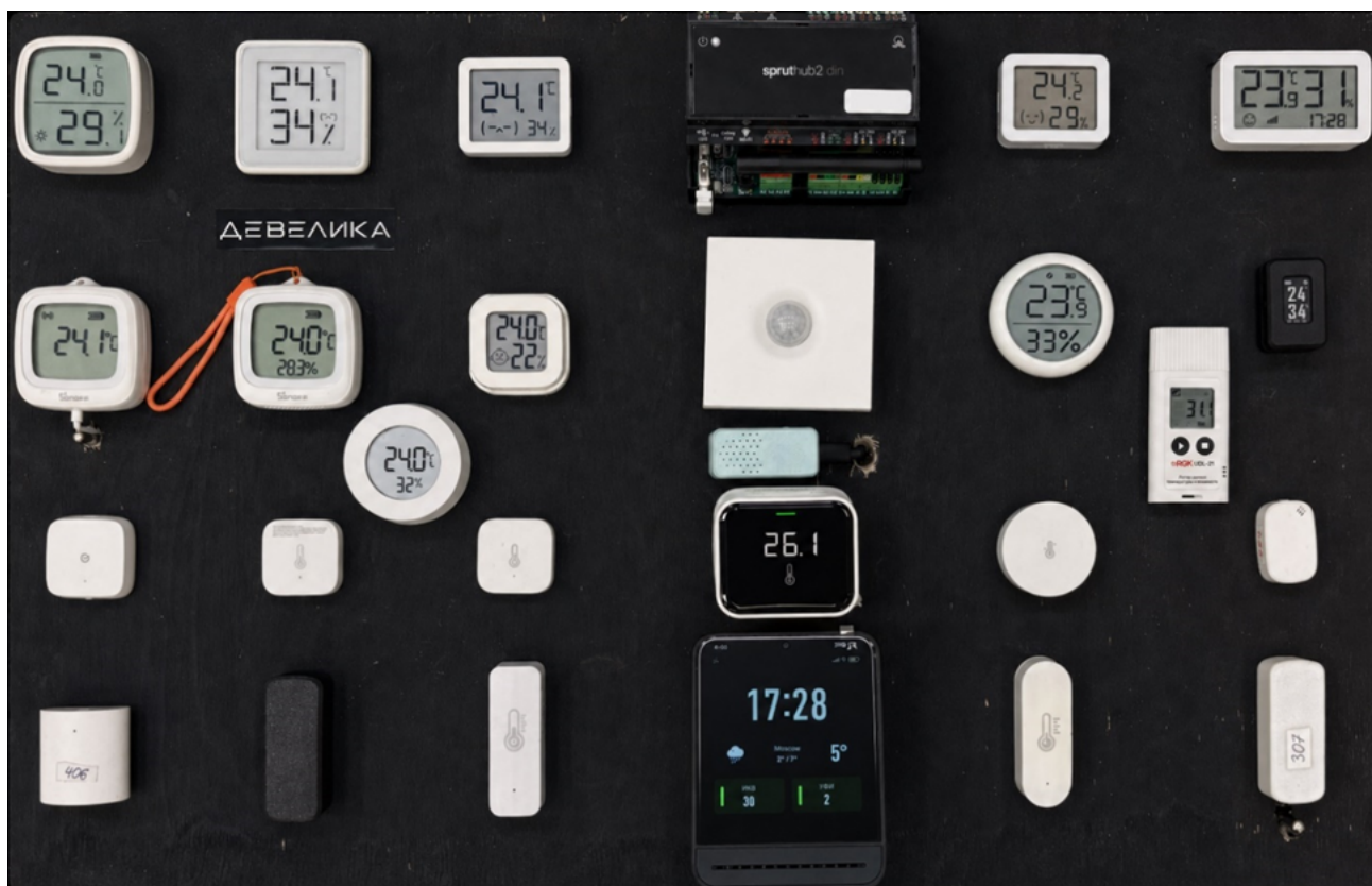
Испытательный стенд: датчики размещены рядом, оба эталона находятся в той же зоне
